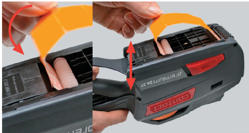
Figure 21 Papier support entre le rouleau de renvoi et la roue de transport
