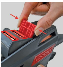
Figure 22 Comprimer les ressorts du tiroir de cliché
