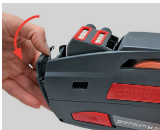
Slika 12 Otvaranje prednje ploče
