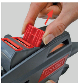
Slika 23 Izvlačenje kliznika za dodatne informacije
