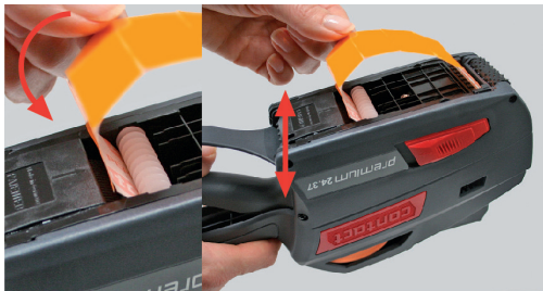
Kép 21 A hordozópapír a terelőgörgő és a továbbítókerék között
