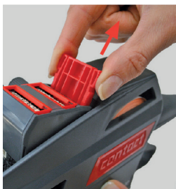
Kép 23 A sablonnyomó kihúzása
