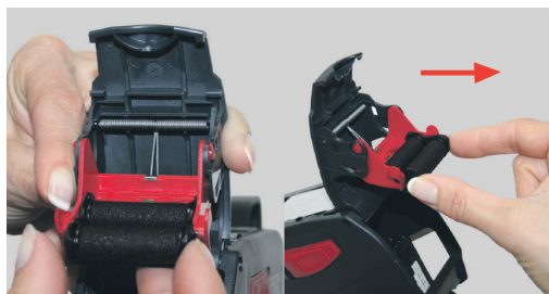
Rysunek 13 Wymywanie rolki farbowej
