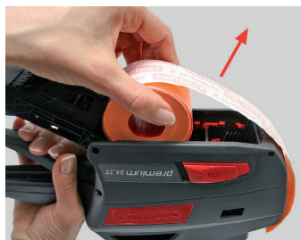
Rysunek 18 Wymywanie rolki etykiet
