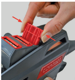
Rysunek 22 Ścisnięcie sprężyn suwaka taśmy
