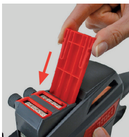
Rysunek 24 Wkładanie i wsuwanie suwaka taśmy
