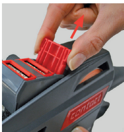
Figura 23 Remover a corredeira do clichê
