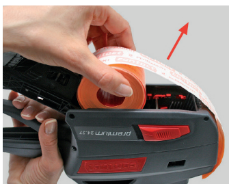
Figura 18 Remover o rolo de etiquetas
