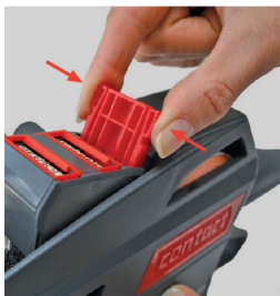
Figura 22 Comprimir as molas da corredeira do clichê
