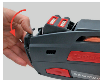
Figura 12 Abrir a placa frontal
