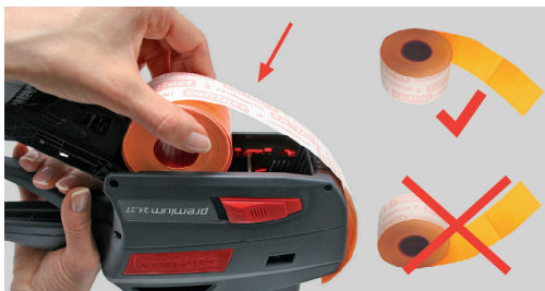
Figura 19 Colocar um rolo de etiquetas
