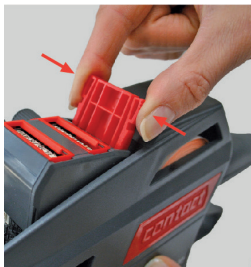
Rysunek 22 Tensionarea culisei de clișee prin comprimare
