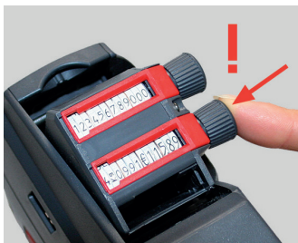
Rysunek 8 Împingeți înapoi butonul de reglare
