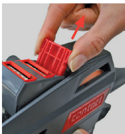
Slika 23 Odstranjevanje drsnika klišeja
