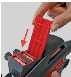
Slika 24 Vstavljanje in potiskanje drsnika klišeja
