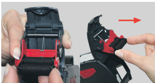
Slika 13 Odstranite barvni valj
