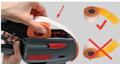
Slika 19 Vstavljanje valja z etiketami
