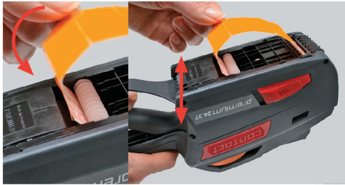
Slika 21 Zaščitni papir med valjem za navijanje in transportnim kolesom
