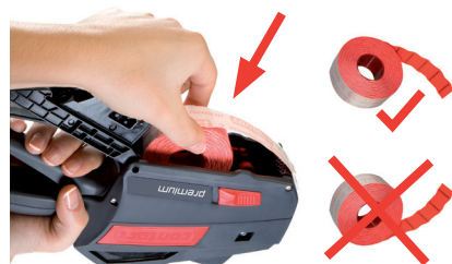
Εικόνα 19 Τοποθέτηση ρολού ετικετών
