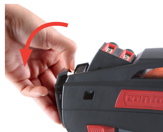
Slika 12 Otvaranje prednje ploče
