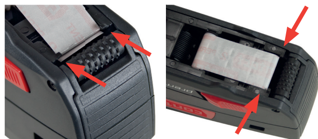
Slika 20 Zaštitni papir iza iglice za vođenje
