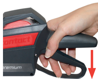
Kép 10 A fogantyú elengedése
