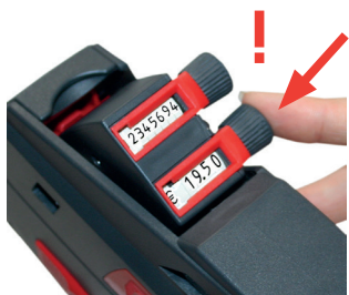
Rysunek 8 Împingeți înapoi butonul de reglare
