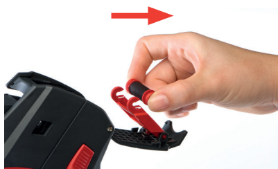
Obrázok 13 Vyberte farebný kotúč
