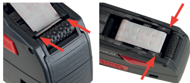
Obrázok 20 Správne umiestnenie etikety za kolímkami
